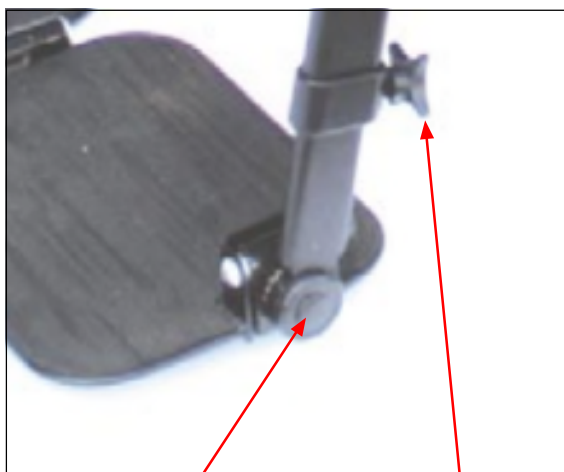
Justeringsskrue (bag hætte) for vinkling af fodplade. Fingerskrue for ændring af fodplades højde.
